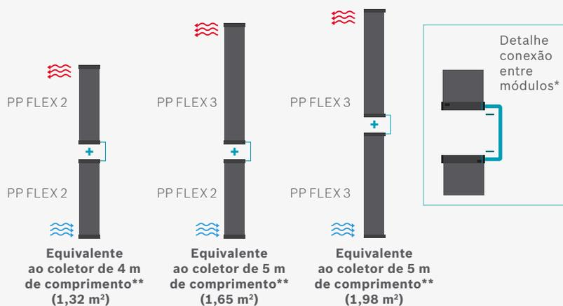
\* A interligação dos coletores instalados em série deve ser feita somente no último coletor de cada bateria.
