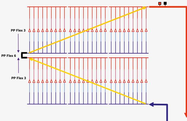
(!) Nos coletores interligados em série o retorno de água quente deve ser feito no mesmo lado da entrada de água fria, para que não haja fluxo de água desigual dentro do coletor.
